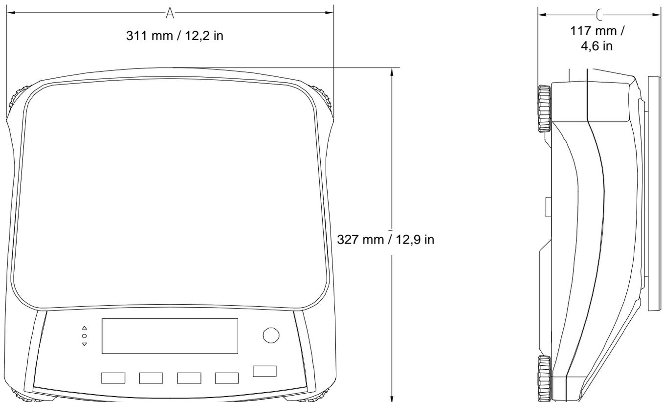
Abbildung 7-1. Abmessungen
