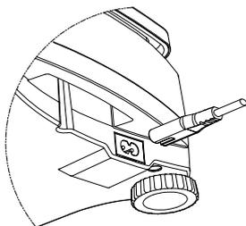
Abbildung 2-3A. Netzstecker mit dem Netzeingang auf der Rückseite der Waage verbinden.
