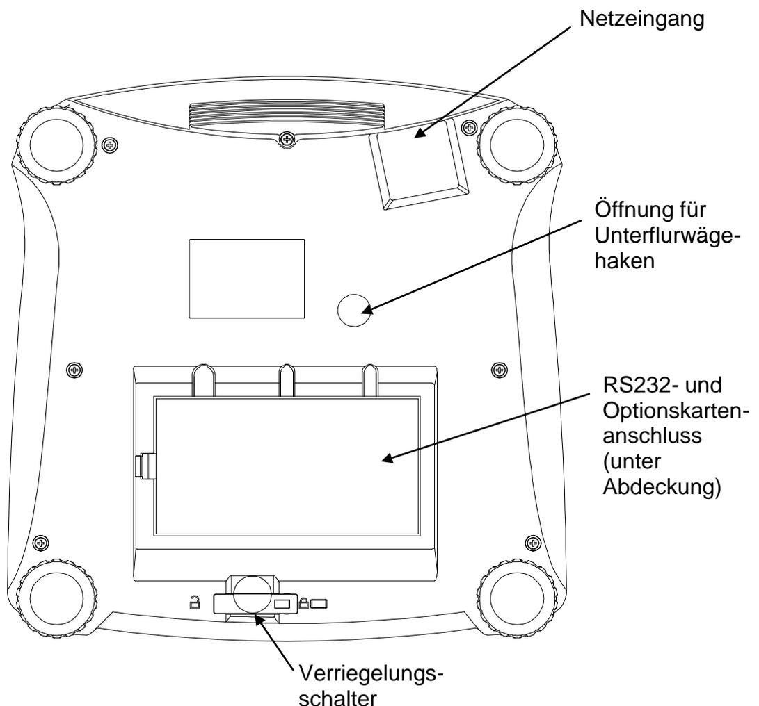
Abbildung 3-4. Unterseite der Racer-Waage
