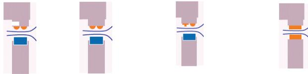
Einzelschweißnaht    Doppelschweißnaht    Trennschweißnaht    2-seitiges Schweißen
